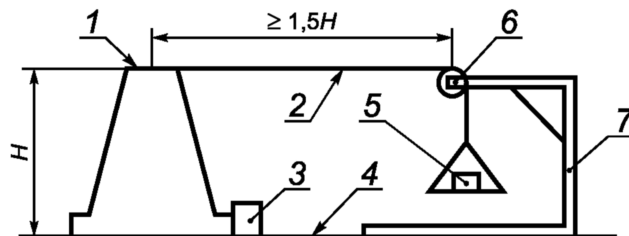
$H$  — высота временного дорожного барьера, временного дорожного щита, дорожного конуса, дорожной пластины, дорожной сигнальной вехи; 1 — временный дорожный барьер, временный дорожный щит, дорожный конус, дорожная пластина, дорожная сигнальная веха; 2 — шнур; 3 — упор; 4 — ровная горизонтальная поверхность; 5 — груз; 6 — блок; 7 — штатив
