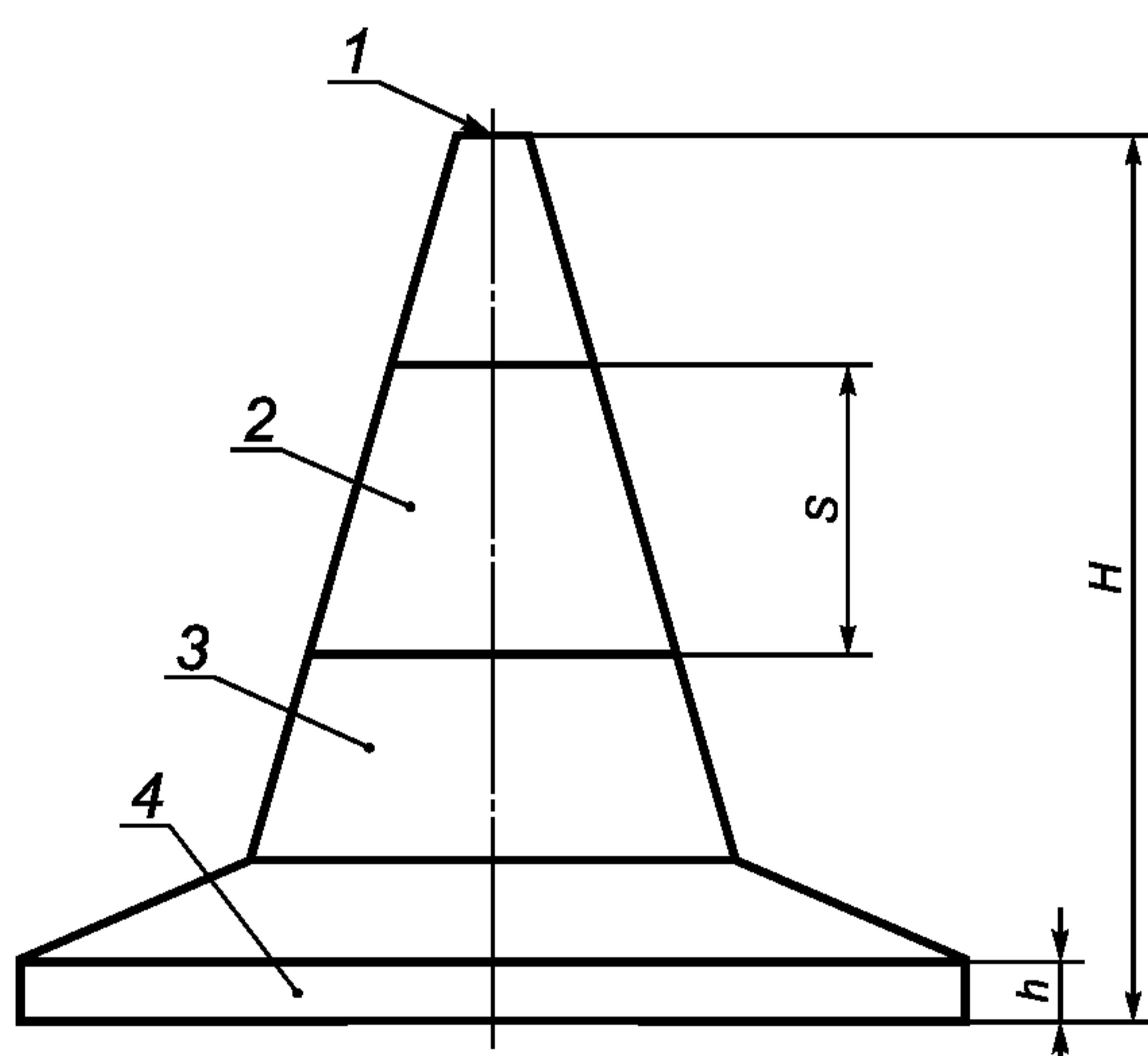
$H$  — высота конуса,  $h$  — толщина внешнего края опорной плиты,  $S$  — ширина световозвращающей поверхности полосы белого цвета, 1 — вершина тела дорожного конуса, 2 — световозвращающая поверхность, 3 — тело дорожного конуса, 4 — опорная плита дорожного конуса
