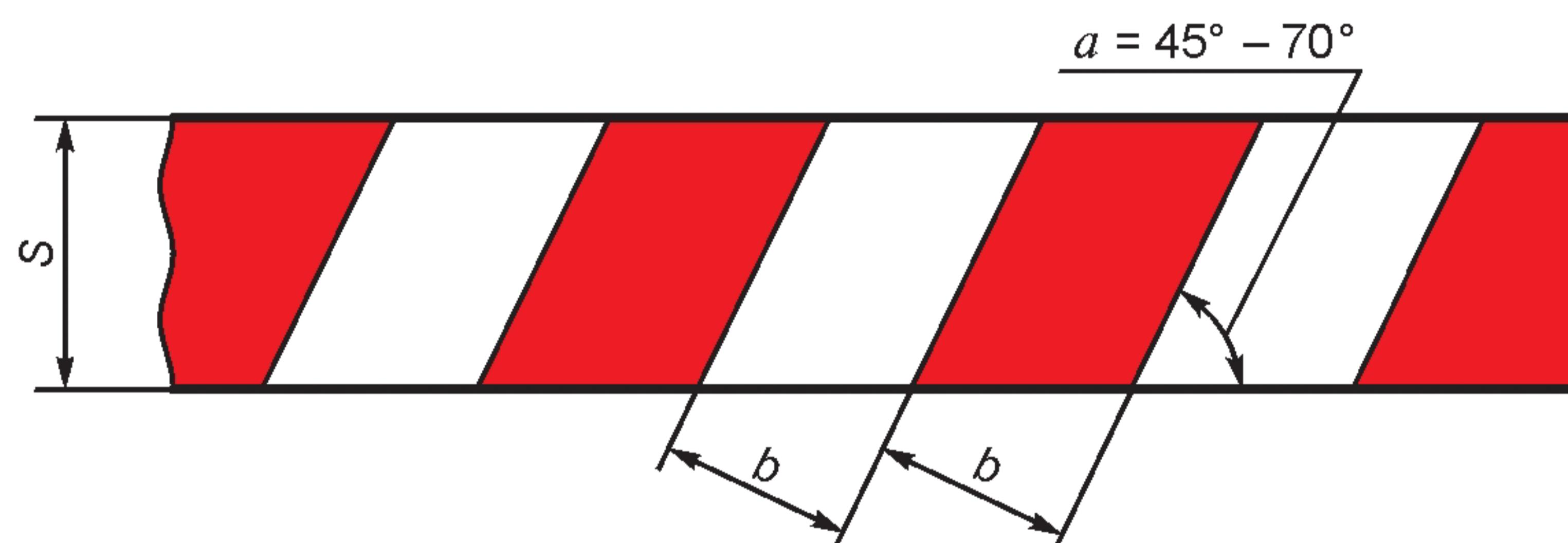
S — ширина дорожной ограждающей ленты, а — угол между красными, белыми полосами и продольной осью дорожной ограждающей ленты, b — ширина красных и белых полос на дорожной ограждающей ленте
